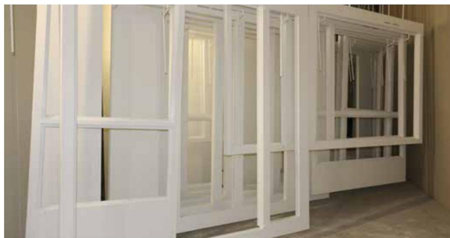
Die Wege zwischen den einzelnen Arbeitsschritten sind kurz und die Fenster werden über die gesamte Produktionsstrasse der Oberflächenbehandlung hinweg hängend transportiert.
